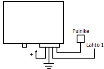
Remuc:in voi lämmittäykäytössä kytkeä ohjaamaan erikseen puhallinta. Tällöin kytetään Lähtö 1 (PIN10) tai Lähtö 2 (PIN11) puhalluksen ohjaukseen, jolloin puhallusta voi ohjata rinnakkain lämmityksen kanssa tai erikseen lämmityksestä riippumatta.
