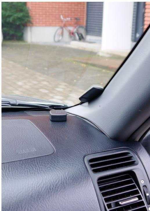
GSM-antennens installationshöjd är av stor betydelse för att uppnå en bra signallnivå. Generellt är det så att, ju högre upp antennen är, desto bättre är signalmottagningen. En bra plats för antennen är exempelvis vindrutans nedre kant.
